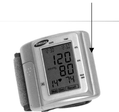
Slika 1: Izgled tlakomjera model SBM 200T s prikazom mjesta za smještaj ovjerne naljepnice
